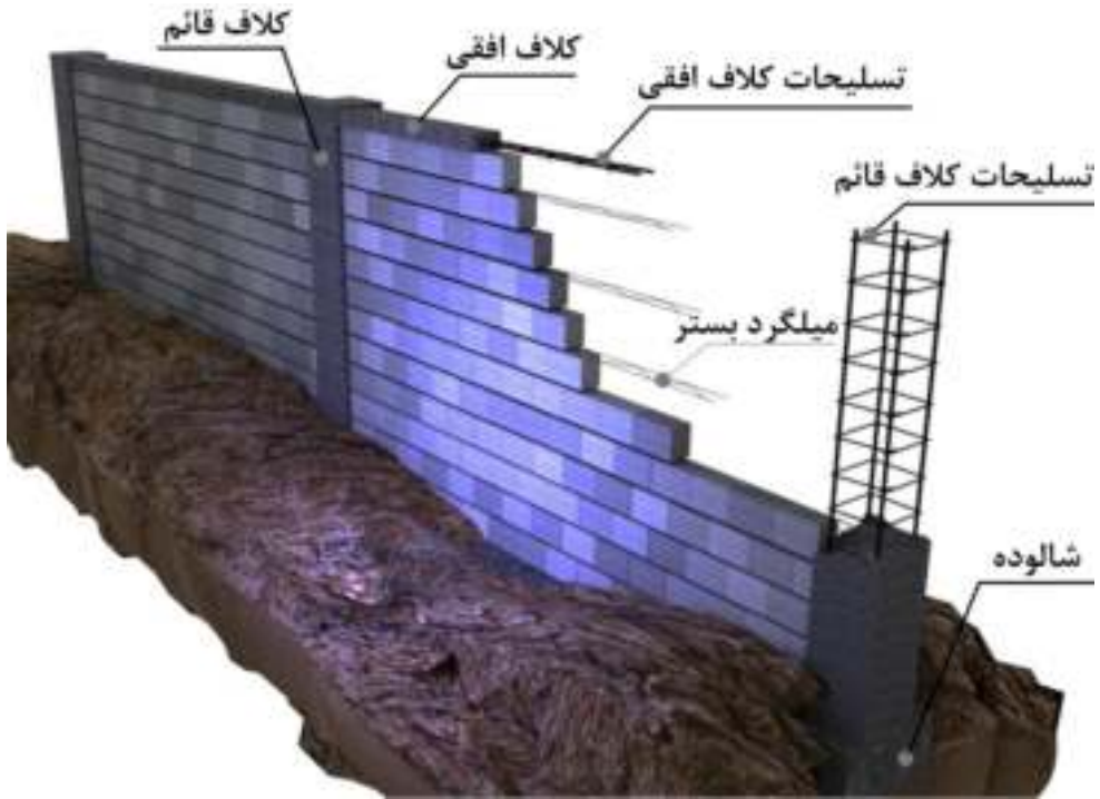
شکل ۱-۲ قسمت‌های اصلی دیوارهای محوطه بنایی
