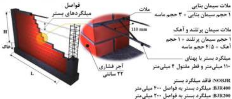
شکل ۳-۴ ظرفیت خارج از صفحه پانل بنایی ۲۲ سانتی ساخته شده از آجر فشاری
